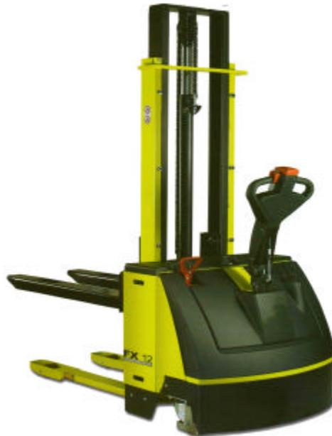
La nouvelle série de gerbeurs électriques FX répond à l'ensemble des besoins de stockage. Le moteur de traction avec technologie SEM (moteur à excitation séparée) assure une vitesse constante avec ou sans charge, et le transistor MOSFET garantit un contrôle précis de l'accélération.
